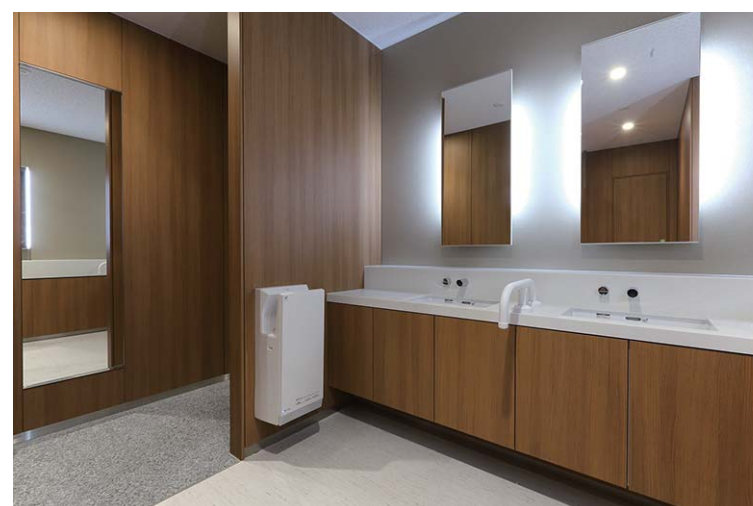
手荷物やポーチなどが置けるドライエリアを備えた洗面カウンター。水栓は汚れにくく清掃しやすい壁付タイプを採用。洗面エリアとは別に設けたパウダーコーナーには、顔全体を照らすフロント照明付鏡を設置し、化粧直しに最適な明るさを確保している。
