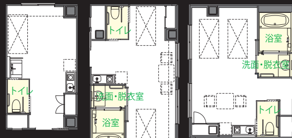
居室 A type (18~19m²) 居室 B type (20~22m²) 居室 C type (33m²) 居室 D type (36m²) 平面図
