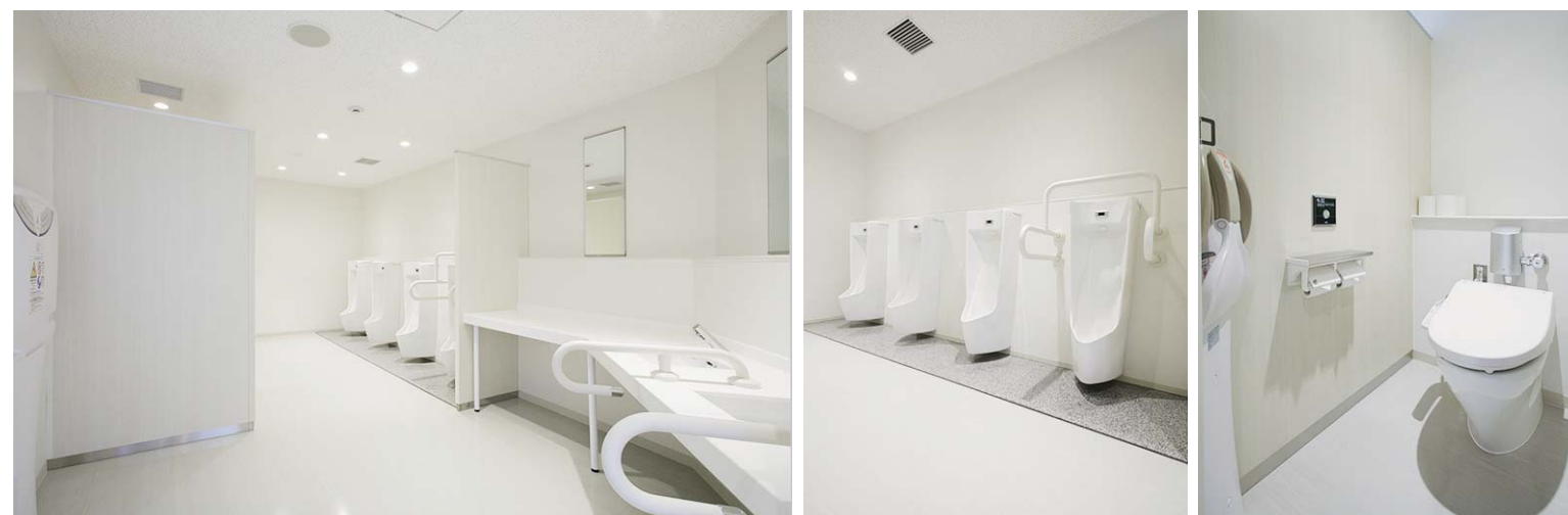
女性トイレだけでなく、男性用トイレにもベビーシートやベビーキープを設置。子ども連れの男性も安心して利用できる。身だしなみのチェックや荷物整理に便利なスタイリングコーナーを洗面エリアとは別に設置し混雑緩和に配慮。小便器や大便器のライニングには手荷物を置くこともできる。
