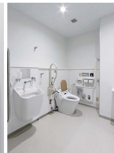
車椅子可動域や介助者の動きを考慮し、十分なスペースを確保した多機能トイレ。着替えに便利なチェンジングボードも備えている。
