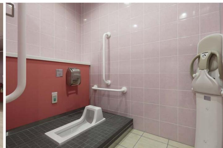
混雑緩和に配慮し、洗面空間とは別にパウダーコーナーが設けられ、落ち着いて化粧直しや荷物の整理をすることができる。洗面空間とパウダー空間は奥行きを取らず平行に設置し、通路幅を確保。様々な利用者に配慮し和風便器を設置したブースは、安全確保の為に各所に手すりを設置している。
