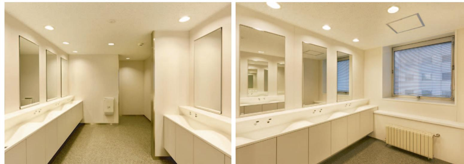
NOSELカウンター上部はドライスペースとなっており、ポーチなどの手荷物を水濡れなく置くことができる。また、奥行き450mmのスリムタイプを採用、鏡に近づきやすくすることで、手洗いだけでなく化粧直し等にも利用しやすくなっている。
