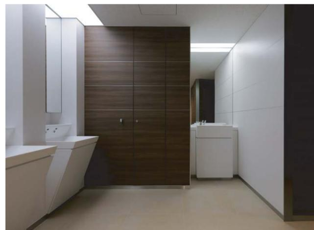
女性の就業者数の変化に対応し、基準階において、女性ブースを各1ヵ所増強。独立性を高めた洗面カウンターには、泡沫式の自動水栓やオートソープも含め清潔感を保つ非接触の機器を採用。また、歯磨きコーナーのほか、比較的大きい個室ブースには着替えやストッキングの履き替えの出来るチェンジングボードも設置。女性のニーズに応える便利な機能をコンパクトにまとめた空間となっている。
