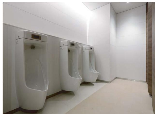
清掃性・デザイン性を備えた超節水6リットル洗浄のパブリック向け壁掛式大便器には、すべてにシャワートイレを装備。小便器には省エネに配慮したセンサー一体形壁掛けストール小便器を採用。また、男女とも個室ブース各1ヵ所ずつに手すりを設置。
