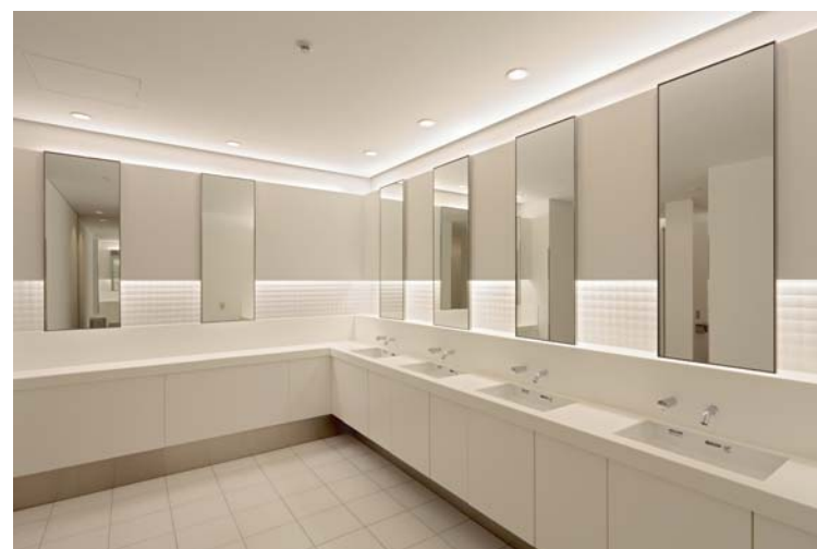
手洗いコーナーとパウダーコーナーがL字に配置された女性用トイレ。水栓はカウンターまわりが汚れにくく、水の止め忘れも防げる衛生的で経済的な自動水栓を採用。個室間の仕切りは天井まで立ち上げられており、利用者同士のプライバシーに配慮。また、横ラインの間接照明やアクセントのパール調タイルも空間に広さと明るさを演出している。
