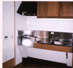
車椅子でも近づけ、上下可動式の流し台
