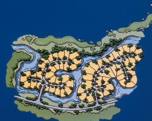
クルドサック（袋小路）のダイヤグラム。ゴルフ場の緑と人工湖で区画を仕切る
