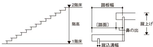
※蹴上げ寸法(階高÷上り切り段数)が230mmを超える場合は加工できません。(建築基準法による)
