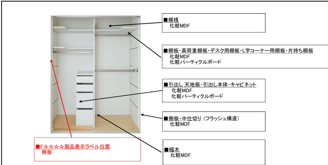
構成材料の詳細情報(ホルムアルデヒド発散区分の根拠、部材別の証明書類)
